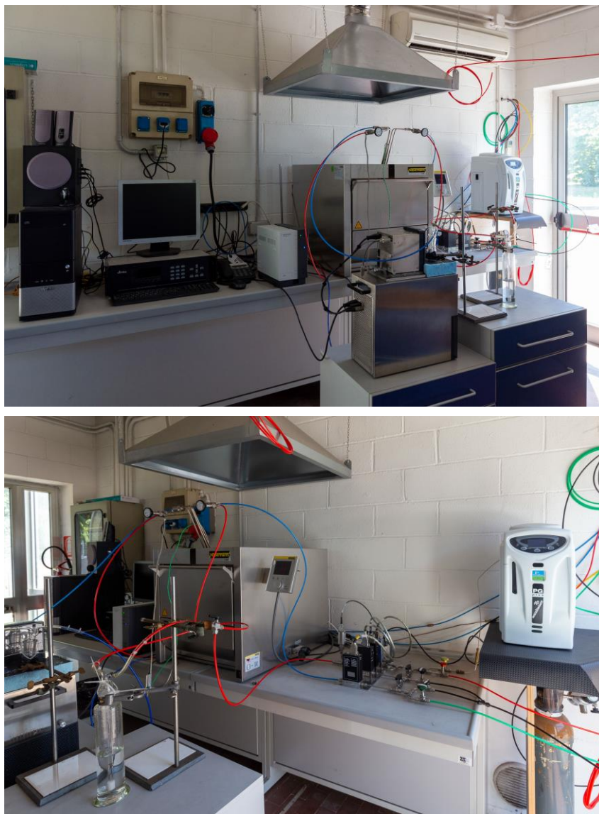
Figura 10. Foto del sistema di misura realizzato per la caratterizzazione catalitica degli elettrodi, comprensivo di muffola per riscaldare la cella di misura, sistema di gestione flussi di gas e umidificazione e gascromatografo a valle per l'analisi dei gas in uscita dalla cella.
