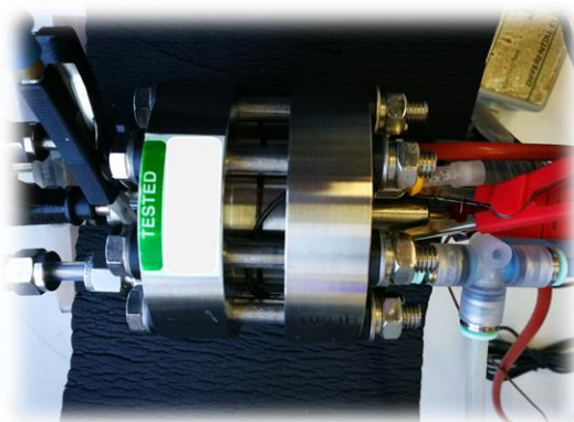
Figura 3. Cella impiegata per i test elettrochimici rigenerativi.
