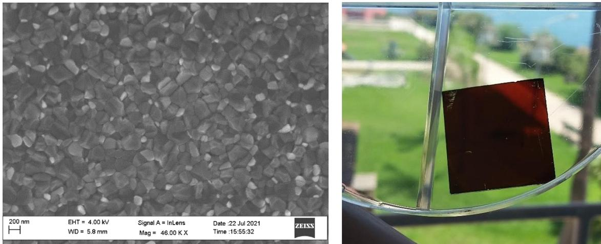
**Figura 2.1.4. Immagine SEM ad alta risoluzione di un film di perovskite a triplo catione e fotografia di un film.**
