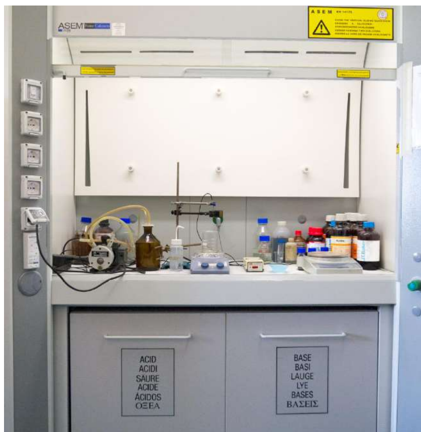
Figura 4. Cappa ad aspirazione utilizzata per il processo di sintesi one-pot dei liquidi ionici.
