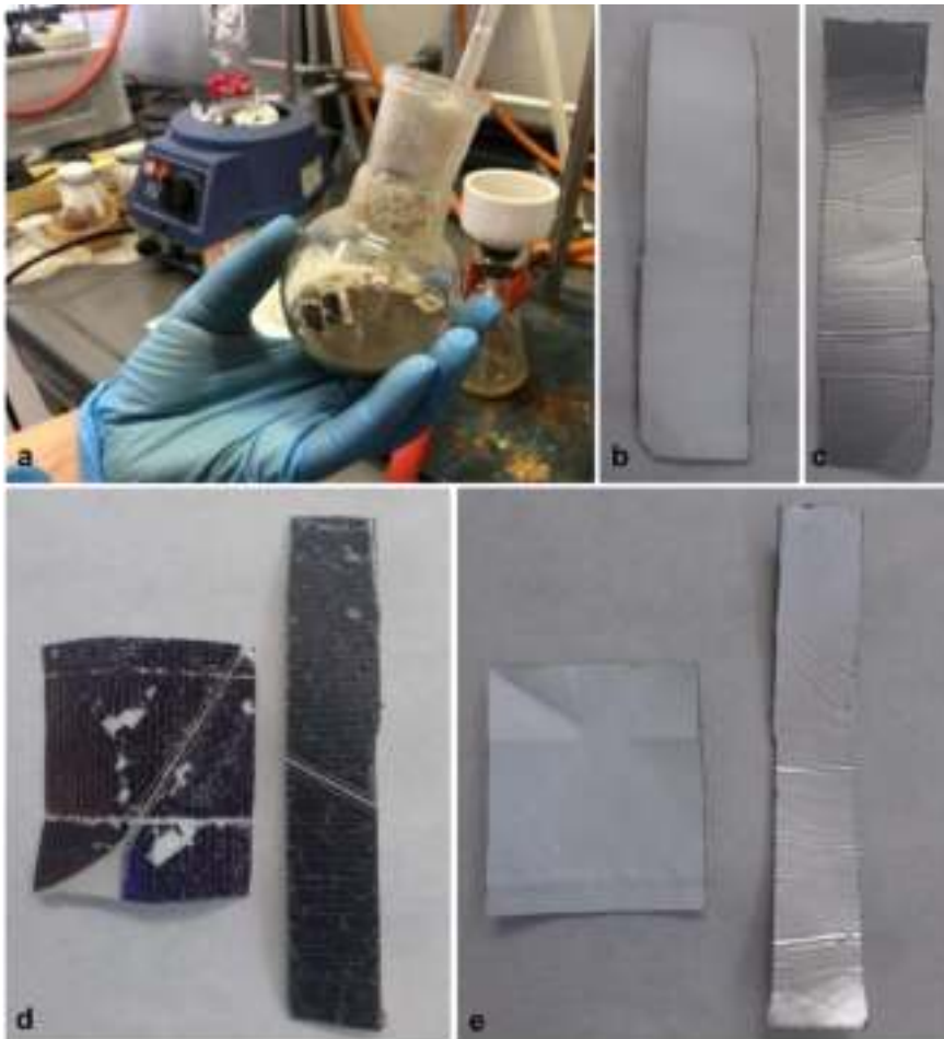
Figura 39. a) Operazione di filtrazione su Büchner della miscela di reazione ottenuta a seguito del trattamento con KOH. b) e c) porzione di backsheet contenente alluminio rimosso dal pannello utilizzato nell'esperimento MI 2. d) ed e) Pannelli PV Sanyo di partenza utilizzati per lo studio di trattamento chimico. In particolare, d) fronte e c) retro del PV Sanyo senza backsheet esterno (sinistra) e del PV Sanyo completo (destra).
