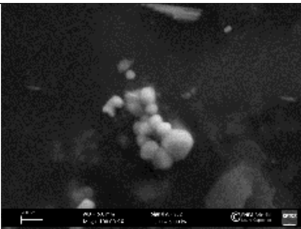
o) Micrografia al SEM delle particelle di polvere con dimensioni nanometriche, dai 200nm ai 70nm
