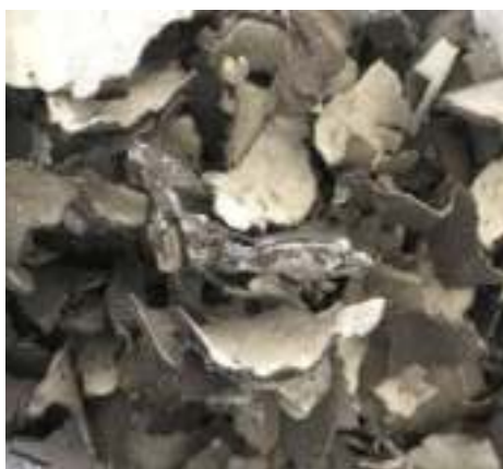
Figura 1. Solar chips ottenuti dalla procedura di smaltimento ERION
