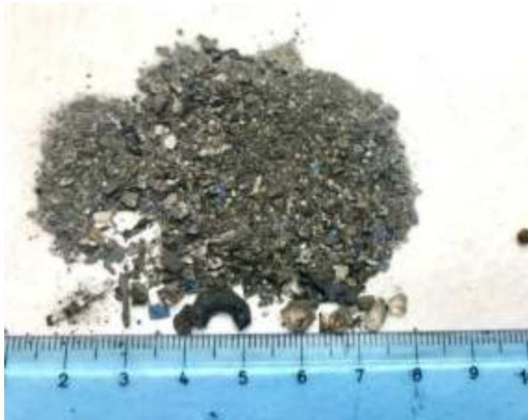
Figura 35. Polvere ottenuta per pirolisi dei frammenti di pannelli fotovoltaici forniti da ECODOM. Il trattamento è stato eseguito a 600 °C per un'ora in atmosfera di Argon presso i laboratori di Faenza.
