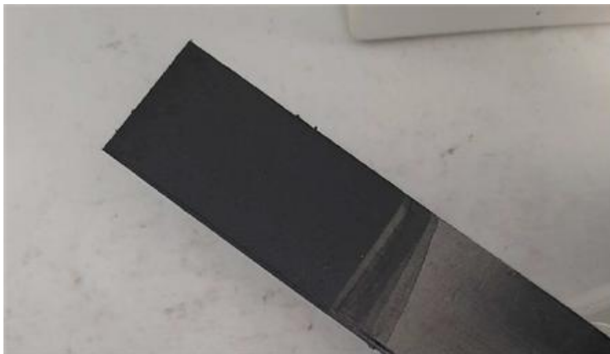
Figura 34. Anodo realizzato con polvere Sanyo Senza Backsheet tramite tecnica EPD.
