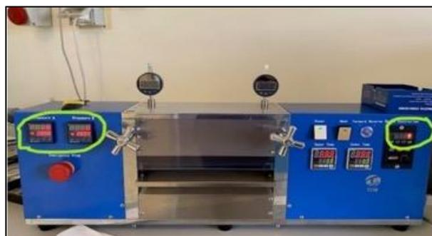
Fig.9. Nanofaber Roll-Press per la laminazione delle membrane.
