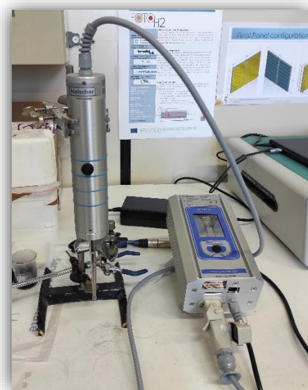
Fig 2. Sonotrodo impiegato per la miscelazione dei catalizzatori.
