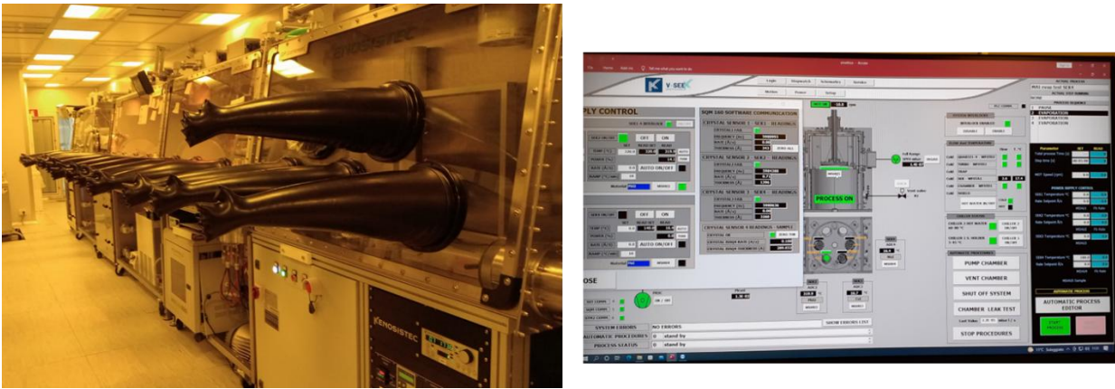
Figura 1. Foto della linea di glovebox del laboratorio TERIN-FSD-DIN del Centro ENEA di Portici (in primo piano la glovebox con evaporatore Kenosistec) e schermata del software di gestione.
