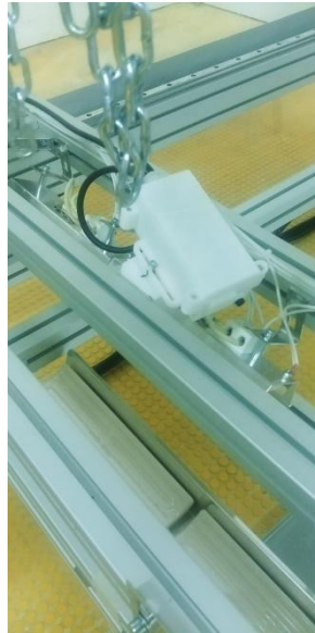
Figura 6–Termocamera montata sul telaio del prototipo e diretta sulla superficie del backsheet
