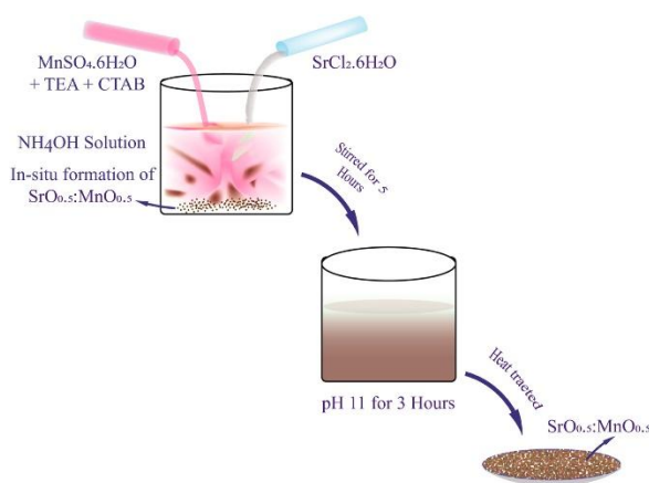
Figura 14 Schema della sintesi delle nanostrutture di ossido di stronzio e ossido di manganese \text{SrO}_{0,5}:\text{MnO}_{0,5} .
