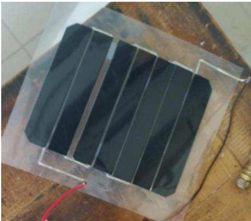
Figura 10 - Minimodulo PV realizzato per il benchmark B1
