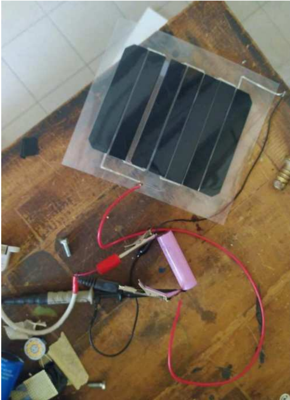
Figura 2 – Esempio di dispositivo di benchmark costituito da un minimodulo homemade di 7 celle di Si cristallino SunPower e da una batteria agli ioni di Litio Samsung 18650 da 2600mAh.
