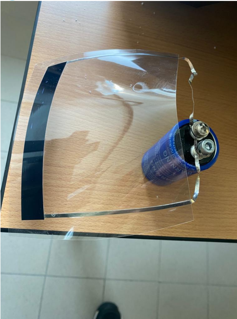
Figura 7 – Prototipo B di cella solare 10x125mm 2 Sunpower, collegata ad un SuperCap Greencap da 2.7V - 500F.
