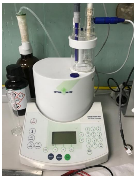
Figura 6. Titolatore automatico (integrato nella procedura automatizzabile di testing) utilizzato per la determinazione del tenore di umidità dei liquidi ionici.
