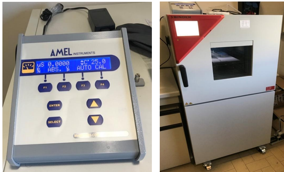
Figura 3. Conduttimetro (pannello sinistro) e camera climatica (pannello destro) utilizzati per le misure di conducibilità ionica specifica eseguite sui liquidi ionici sintetizzati in LA2.4. Gli strumenti sono integrati nel protocollo di testing automatizzabile
