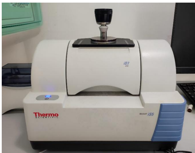
Figura 3. Spettroscopio FT-IR utilizzato per le analisi di qualità (struttura chimica) dei liquidi ionici.
