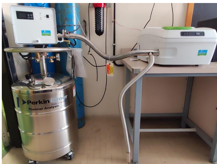
Figura 5. Calorimetro DSC equipaggiato con Cryofill utilizzato per le analisi termiche dei liquidi ionici.
