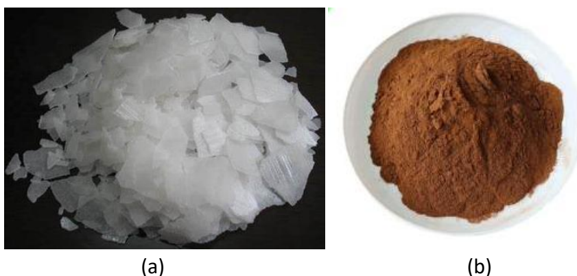
Figura 13. Idrossido di manganese (a) e ossido di manganese (b)
