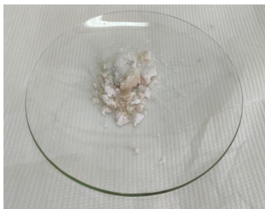
Figura 20 Acetato di litio bi-idrato proveniente dalla distillazione del lisciviato del materiale NMC con acido acetico glaciale
