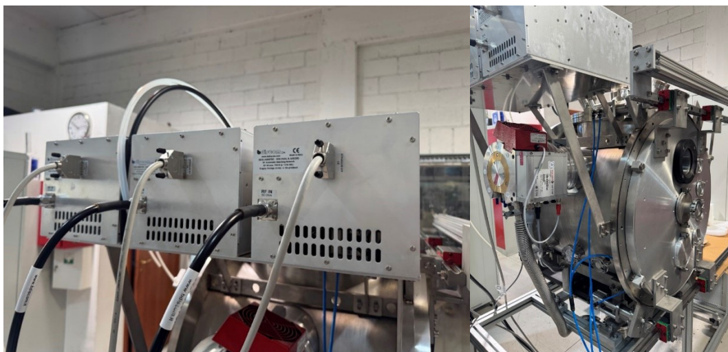
Figura 3 Dettaglio e posizionamento delle reti di accoppiamento delle alimentazioni RF delle sorgenti
