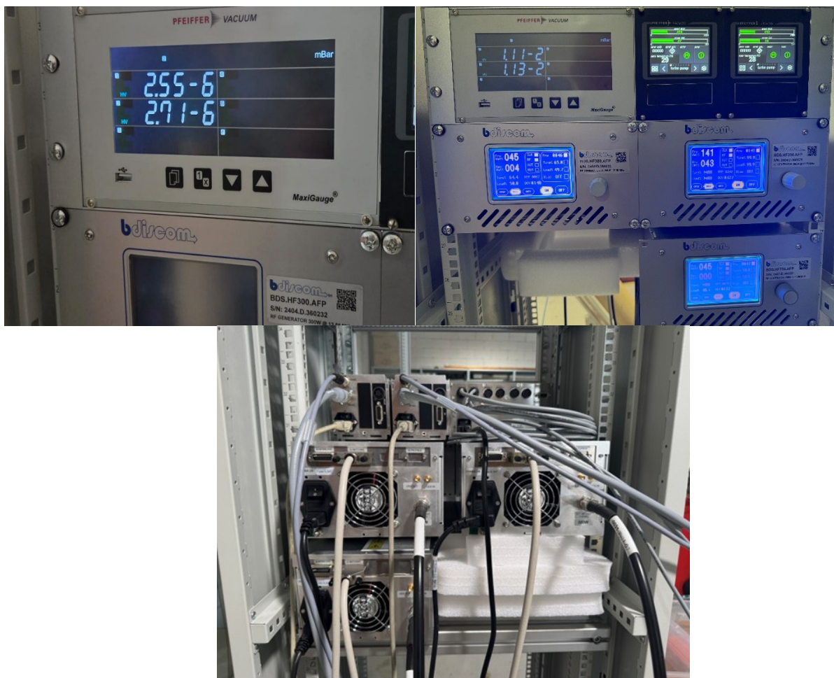
Figura 5 Dettaglio dell'apparato di controllo delle sorgenti e del sistema da vuoto durante le operazioni di vuoto iniziale a sinistra, bassa pressione di argon con tre sorgenti accese a destra, in basso la vista dei controller e delle interfacce digitali
