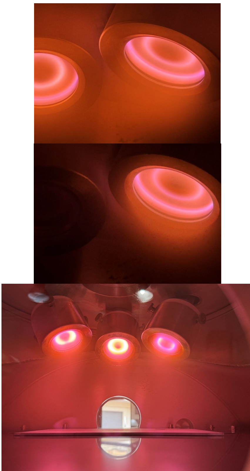
Figura 8 La sorgente al plasma durante le operazioni, sopra co-sputtering con due sorgenti, al centro con singola sorgente. In basso operazioni di deposizione con tre sorgenti operanti a 50W di potenza
