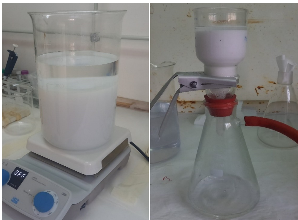
Figura 20. Sezione 3b - il recupero del litio: precipitazione e filtrazione
