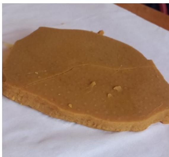
Figura 16 Precipitato di fosfato ferrico umido ottenuto attraverso le operazioni relative alla Sezione 2. (cfr. Figura 15 C)
