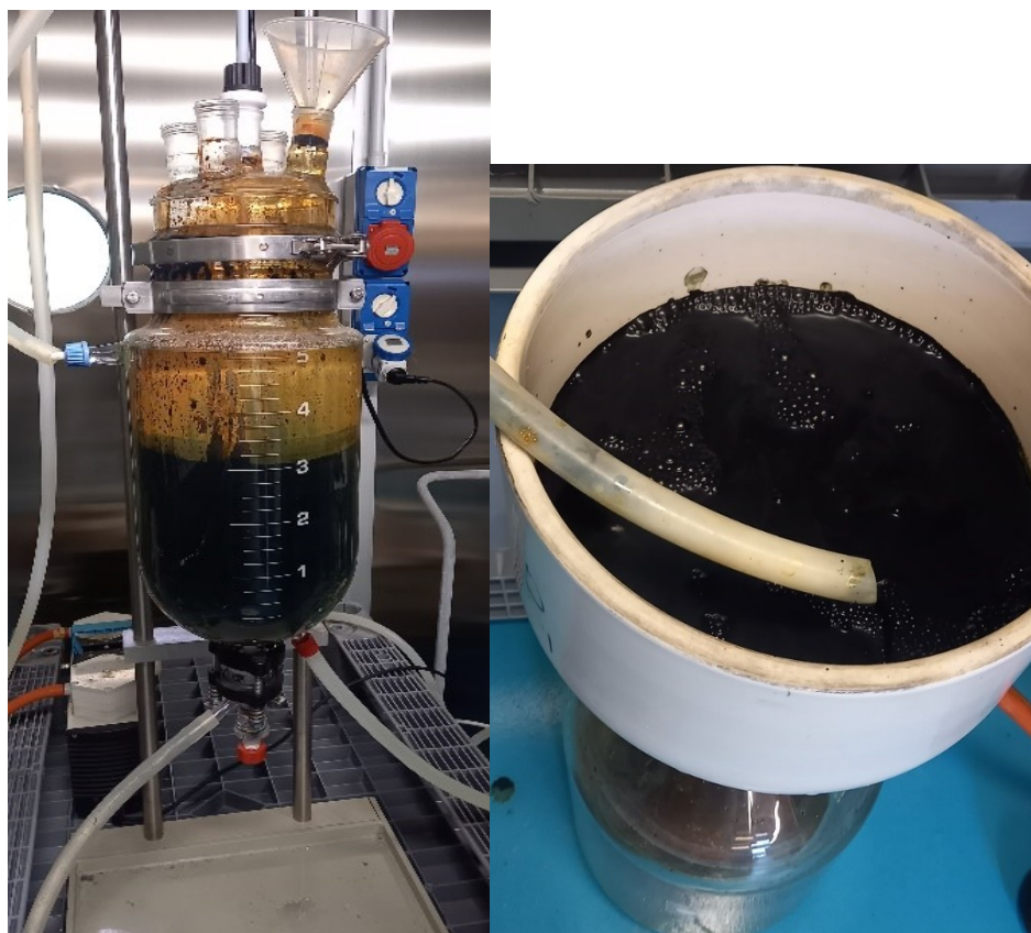
Figura 18. Sezione 3a: Rimozione del ferro mediante precipitazione come idrossido
