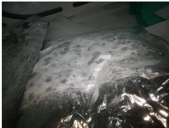
Figura 3. Esempio di danneggiamenti da dripping di un campione durante un transitorio dovuto allo spegnimento del generatore primario ed in assenza di dummy collector (cortesia della Nanofabersrl)
