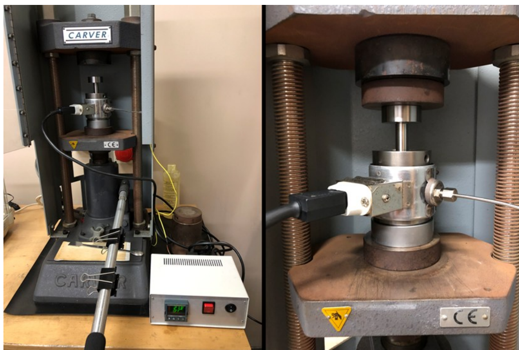
Figura 10. Foto della pressa, dello stampo con camicia riscaldata e del relativo controller per il controllo della temperatura.
