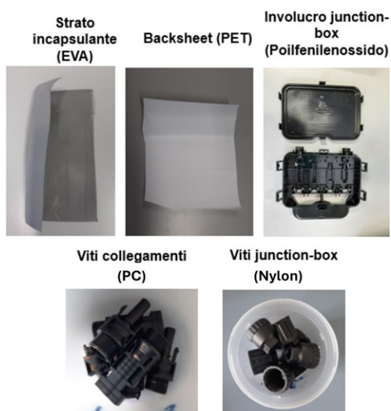
Figura 48: Componenti del pannello fotovoltaico costituite da polimeri plastici
