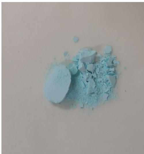
Figura 41: Precipitato di ossalato di rame (bandelle PV tipo A)
