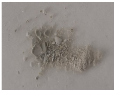
Figura 39: Precipitato di Sn ottenuto dalle bandelle
