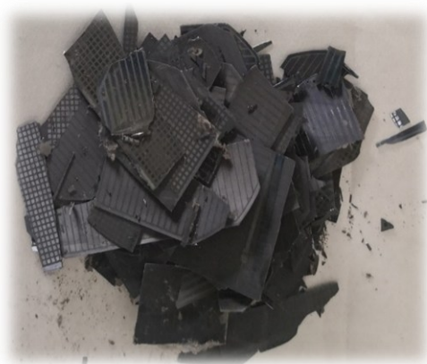
Figura 31: Residuo solido ottenuto dopo la lisciviazione delle celle
