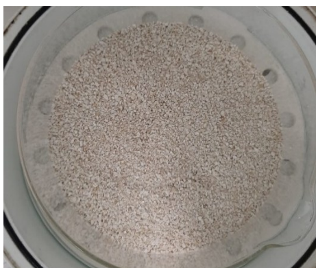
Figura 53: PET in scaglie utilizzato nel processo di estrusione
