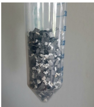
Figura 57: Campione di plastiche dei pannelli utilizzato per la pirolisi
