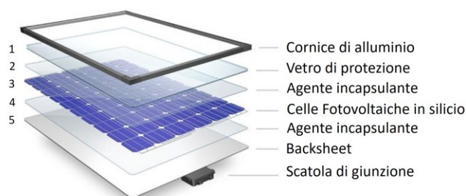
Figura 1: Tipica struttura di un pannello fotovoltaico a base silicio
