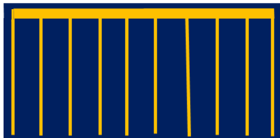
Fig.3: Layout griglia metallica cella InGaP su Si
