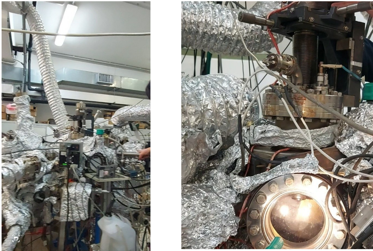
Figura 1.3.2 Sistema per evaporazione in ultra-alto vuoto tramite Molecular Beam Epitaxy sviluppato presso il CNR
