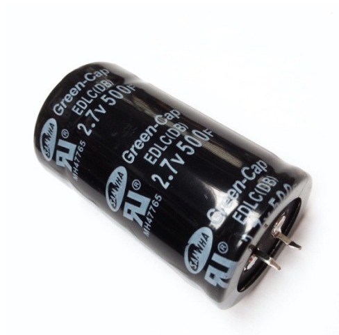
Figura 5 - Supercapacitore EDLC ad alta capacità utilizzato nei dispositivi di benchmark.
