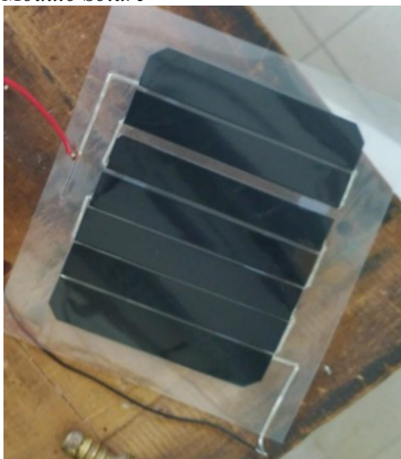
Figura 1 - Modulo solare utilizzato nei dispositivi di benchmark
