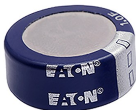
Figura 6 - Supercapacitore EDLC a bassa capacità utilizzato nei dispositivi di benchmark.
