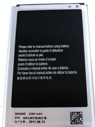
Figura 3 – Batteria piana al Litio utilizzata nei dispositivi di benchmark.
